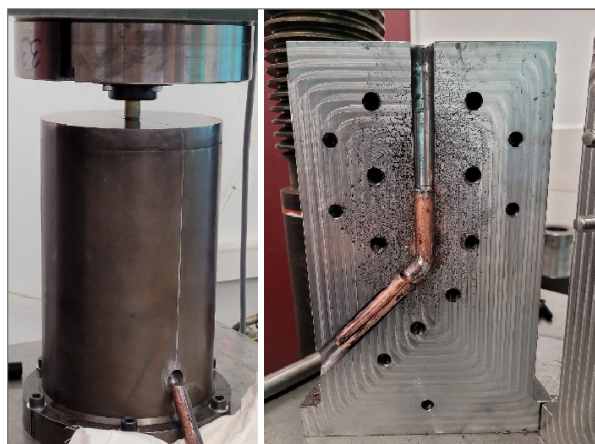
Rys. 72. Proces ECAP 120° oznacza odkształcanie plastyczne tytanu metodą ECAP (wyciskanie przez kanał o jednakowym przekroju). Fot. IWC PAN
